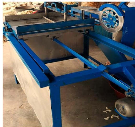
Gambar 2. Mesin Pengiris Ubi Kayu yang dihibahkan Kepada Mitra
