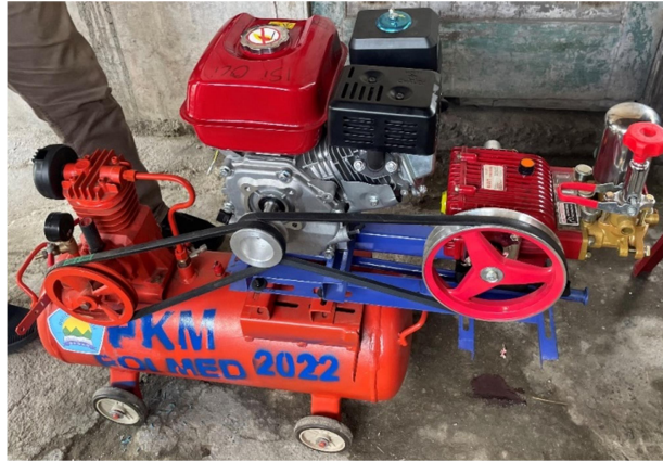
Gambar 1 Mesin Doorsmeer dan Isi Angin Ban
