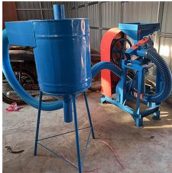
Gambar 6. Mesin Pemisah Kulit Ari Kedelai
