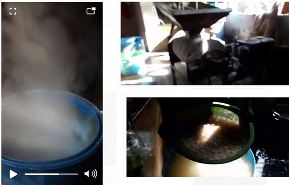
Gambar 3. Proses Pemisahkan Kulit Ari Kedelai Sederhana
