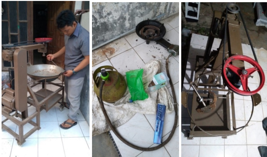
Gambar 5. proses perancangan peralatan alat pengaduk otomatis
