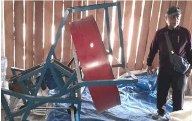
Gambar 3. Mesin granul pupuk yang diterapkan
